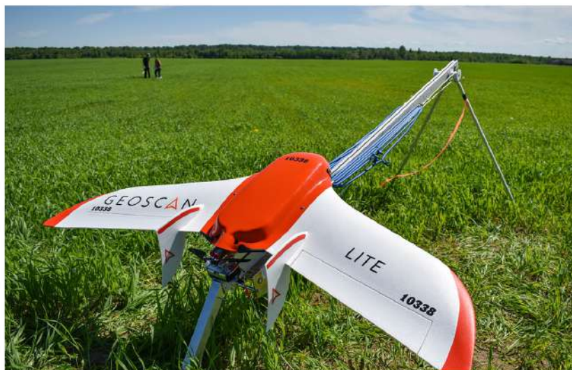
● Аэрофотосъёмку полей проводят с помощью беспилотника самолётного типа
