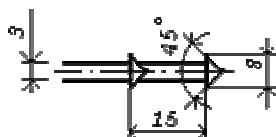
Указание последовательности операций в технологическом процессе изготовления предметов труда, направление их перемещения
