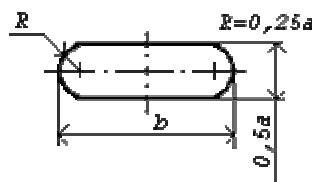
Начало, конец, прерывание процесса обработки данных или выполнения программы
