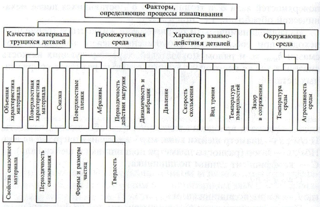
**Рис. 7. Основные факторы, определяющие процессы изнашивания в машинах и оборудовании.**
