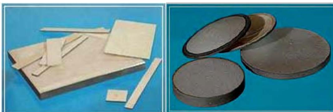
Рис. 3.2 Первоначальный вид образцов из пьезокерамики ЦТС
