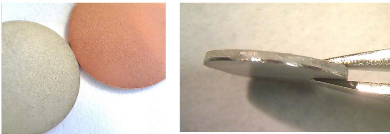
Рис. 3.5 Образцы ЦТС с напыленным подслоем V-Cu и гальванически осажденным Ni
