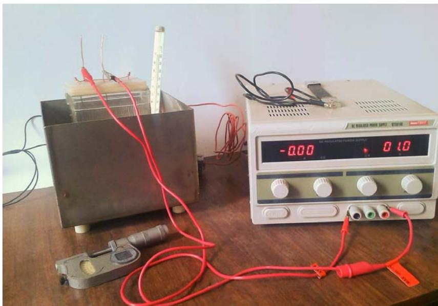
Рис. 3.4 Установка для электролитического осаждения никеля
