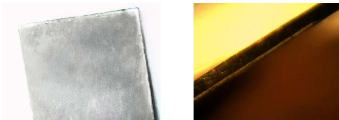
Рис. 3.6 Образцы из арсенида галлия с гальванически осажденным слоем никеля
