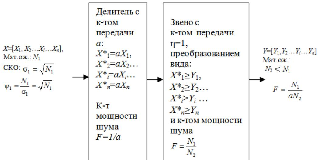
Рис.6.10. Информационная модель фотоэлектронного преобразования
