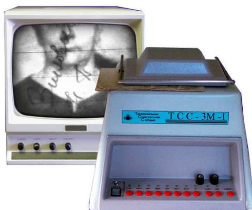
**Рис. 3.11.** Внешний вид телевизионной спектральной системы ТСС -3М
