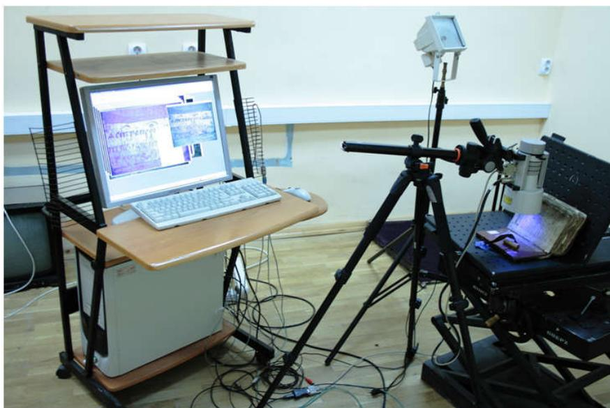
**Рис.3.18.** Вариант установки ТСС Криминалист в ОР РНБ для проведения исследования рукописно-книжных памятников
