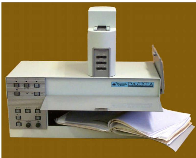
Рис.3.13. Телевизионная спектральная система "Радуга-2"
