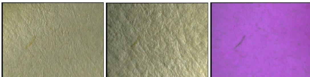
**Рис.3.25.** Пример изображений, получаемых в видимой области спектра при прямом (слева) и косопadaющем (в центре) освещении и при ультрафиолетовой люминесценции (справа)
