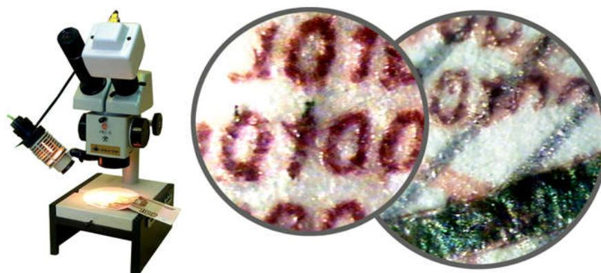
**Рис.7.10.** Внешний вид стандартного микроскопа с телевизионной камерой, установленной на окуляр и изображение наблюдаемого микротекста
