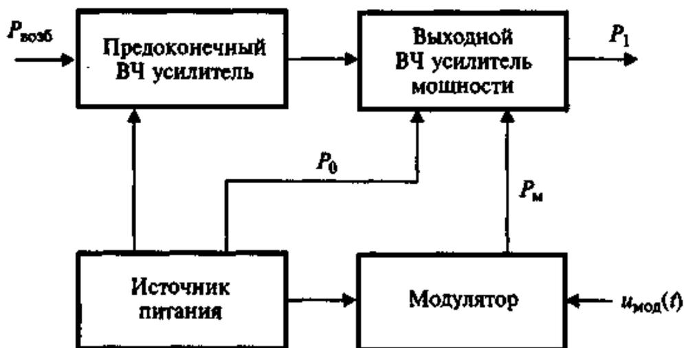
Рис. 15.5. Структурная схема усилительного тракта РПДУ передатчика с АМ
