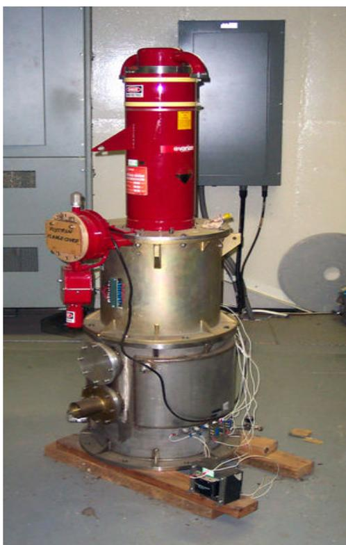
Рис. 3.8 Клистрон в Космическом исследовательском центре в Канберре
