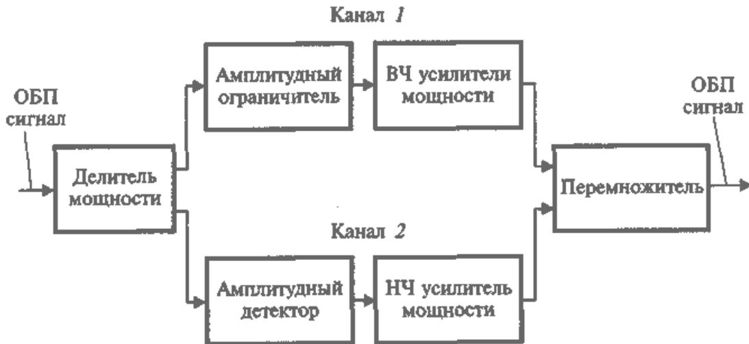
Рис. 16.4. Схема двухканального усилителя для отдельного усиления сигналов с фазовой и амплитудной модуляцией
