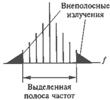
Рис. 15.1. Допустимая полоса излучения спектра модулированного сигнала
