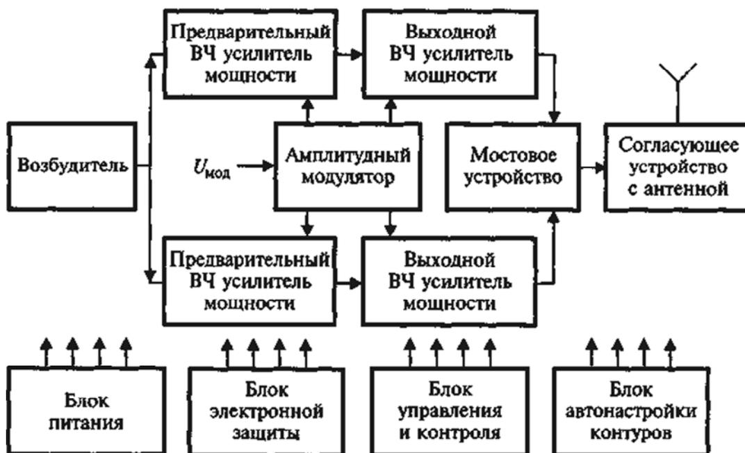
Рис. 20.1. Типовая структурная схема радиопередатчика с амплитудной модуляцией
