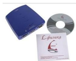
**Компьютерный измерительный блок.** Блок подключается к компьютеру через последовательный порт и с его помощью можно измерять интервалы времени от 0,1 мс по 2-м каналам и управлять одним электронным переключателем.
