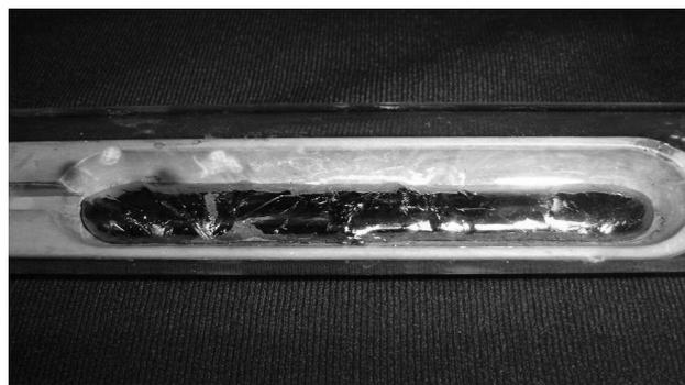
Рис.6. Слиток синтезированного в горизонтальной печи CdGeAs<sub>2</sub>, масса 250 граммов
