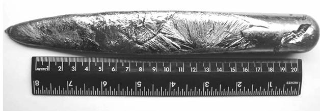
Рис.7. Слиток синтезированного CdGeAs<sub>2</sub> в наклонном варианте печи с вращением реактора, масса 500 граммов
