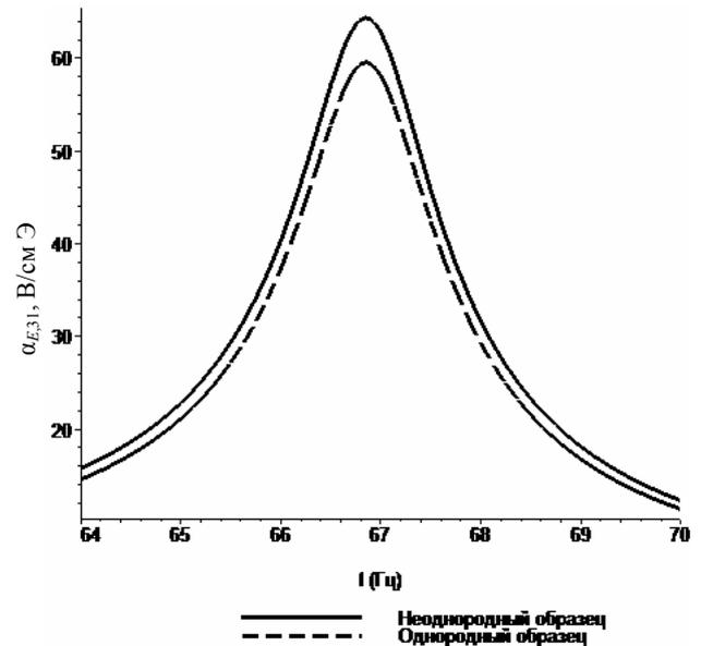
Рис.2. Частотная зависимость МЭ коэффициента по напряжению для структуры ЦТС-ЦТС-пермендюр для параллельно (однородный образец) и встречно поляризованных слоев ЦТС. Толщина слоев ЦТС равна 0,1 и 0,3 мм
