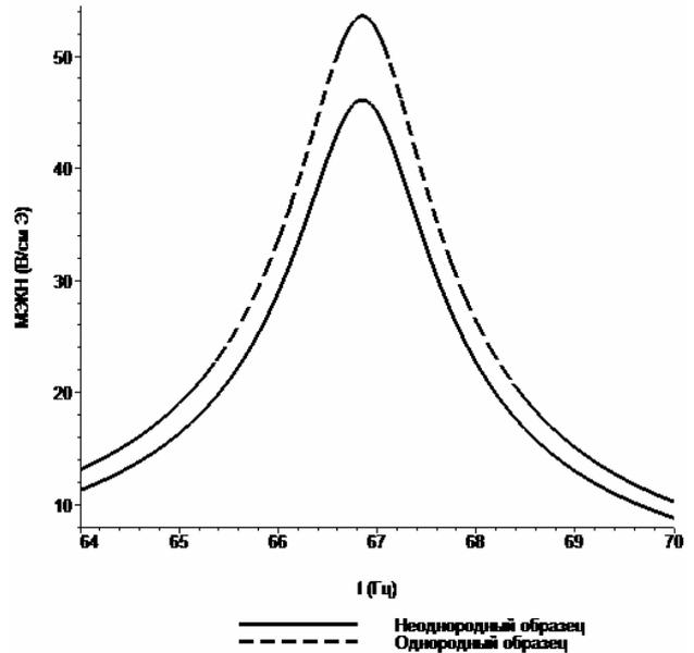
Рис.1. Частотная зависимость МЭ коэффициента по напряжению для структуры ЦТС-ЦТС-пермендюр для параллельно (однородный образец) и встречно поляризованных слоев ЦТС. Толщина каждого слоя ЦТС равна 0,2 мм
