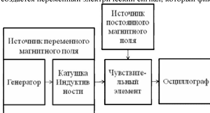
Рис. 1. Структурная схема измерительного стенда
