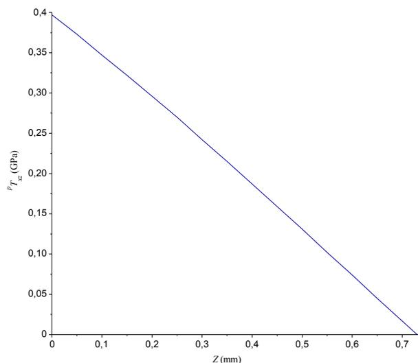
Рис.4. Зависимость напряжения сдвига в пьезоэлектрической фазе по толщине пьезоэлектрика. Частота переменного магнитного поля  $f = 300$  кГц
