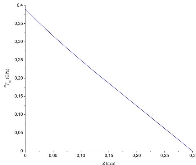
Рис.3. Зависимость напряжения сдвига в магнитострикционной фазе по толщине феррита. Частота переменного магнитного поля  $f = 300$  кГц
