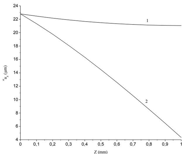
Рис.2. Зависимость смещений среды магнитострикционной и пьезоэлектрической фаз по толщине образца. 1 — магнитострикционная фаза, линия 2 — пьезоэлектрическая фаза. Частота переменного магнитного поля  $f = 300$  кГц
