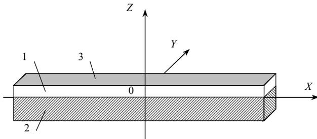
Рис. 1. Схематическое изображение структуры: 1 — магнитоэлектрический слой, 2 — пьезоэлектрический слой, 3 — электроды
