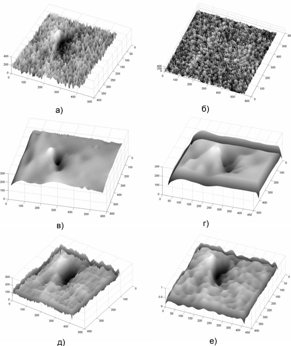
Рис.3. Трехмерные проекции исходного изображения дислокации 1 методами АПРЛ (а) и Ланга (б) — обработанного методом вейвлет-фильтрации с мягким порогом (в) и жестким порогом (г) отсечения детализирующих коэффициентов; обработанного с помощью прямого изменения амплитуд Фурье-спектра (д) и низкочастотной Фурье-фильтрации изображения (е)
