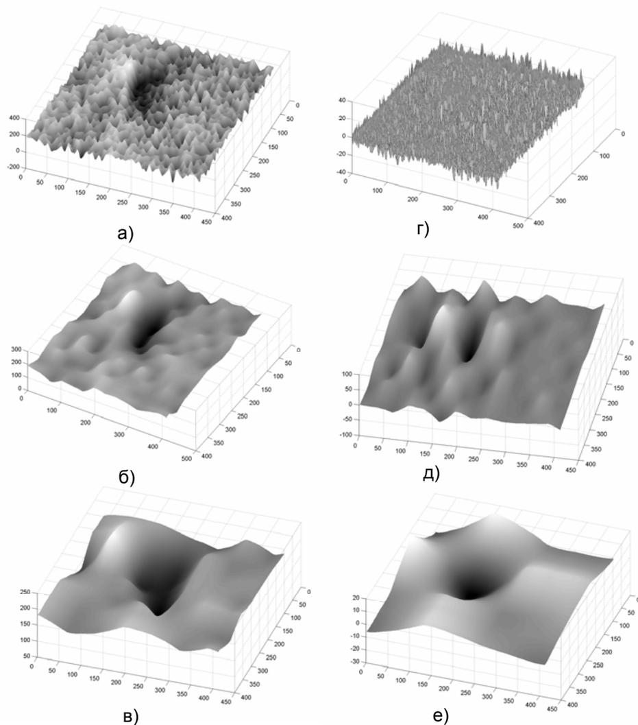
Рис.4. Трехмерные проекции реконструкции контраста дислокации 1 из следующих вейвлет-коэффициентов: коэффициентов аппроксимации 3-го (а), 5-го (б) и 6-го (в) уровней; горизонтальных детализирующих коэффициентов 1-го уровня (г); вертикальных детализирующих коэффициентов 6-го уровня (д); диагональных детализирующих коэффициентов 8-го уровня (е)
