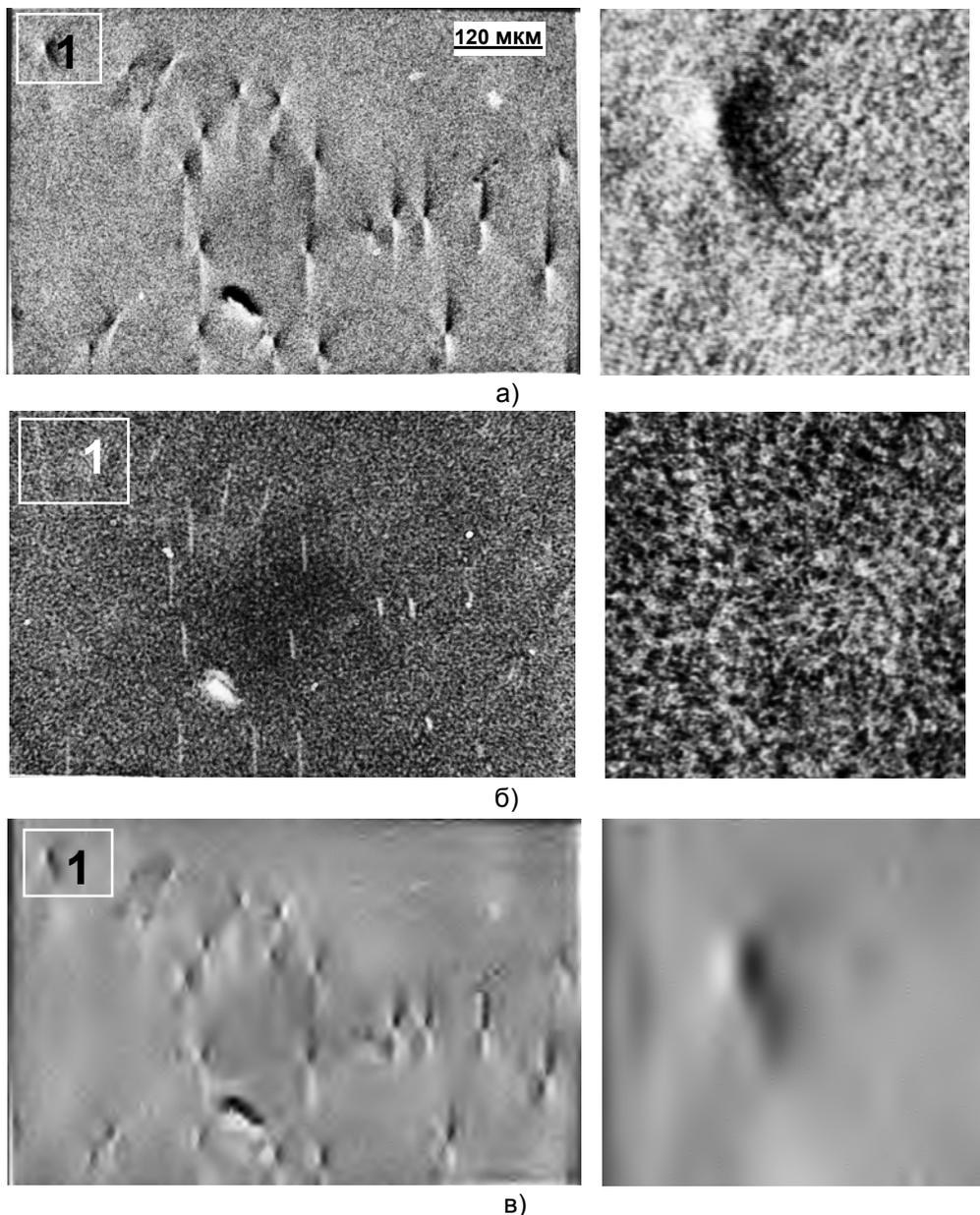
Рис.2. Исходное топографическое изображение краевых дислокаций монокристалла 6H-SiC, полученное методами АПРЛ (а), Ланга (б) и обработанное методом вейвлет-фильтрации (в). Справа от топограмм представлены увеличенные изображения дислокации 1
