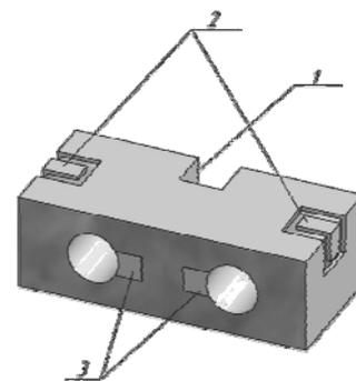
Рис.3. Внешний вид конструкции малогабаритного керамического фильтра на основе коаксиальных резонаторов. 1 — паз; 2 — копланарные линии, образующие «вход» и «выход» фильтра; 3 — проводящие площадки
