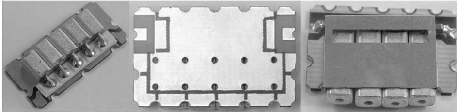
Рис.2. Современная конструкция малогабаритного керамического фильтра на основе дискретных резонаторов
