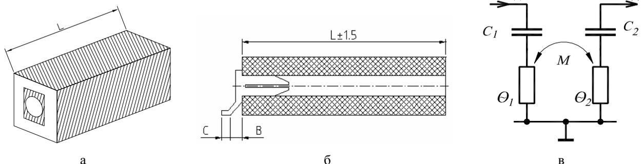
Рис.1. Керамический резонатор: а — внешний вид; б — резонатор в разрезе; в — эквивалентная схема двухрезонаторного фильтра
