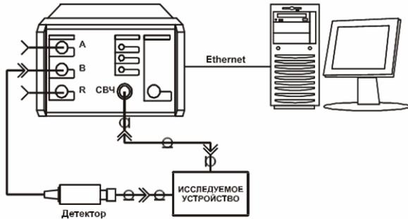
Рис.4. Схема включения прибора P2M-18 для измерения модуля коэффициента передачи
