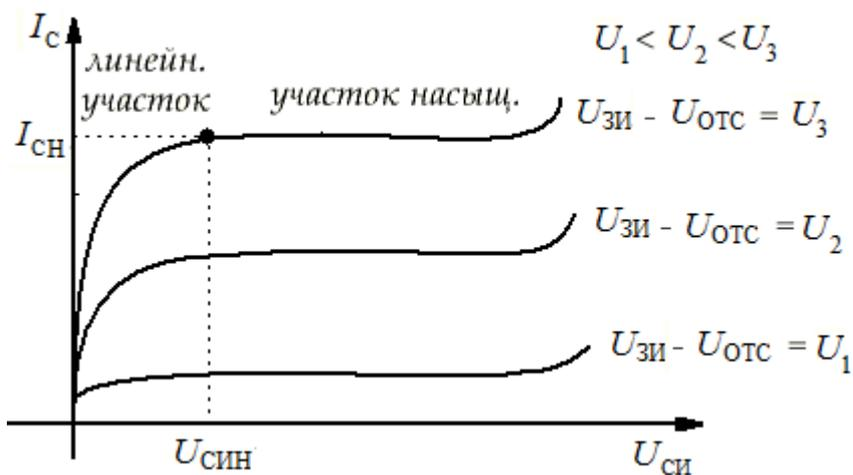
Рис. 11.8. Участки стоковой характеристики МОП-транзистора
