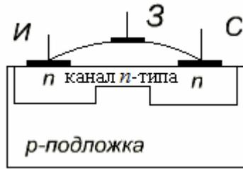
**Рис. 11.5.** Структура МОП-транзистора со встроенным каналом  $n$ -типа
