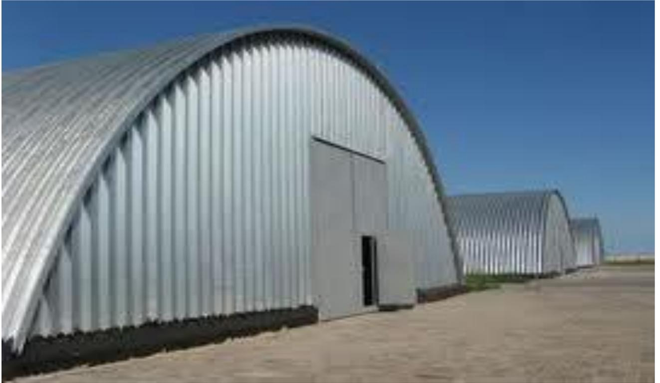
**Рисунок 4** – Внешний вид бескаркасного арочного хранилища
