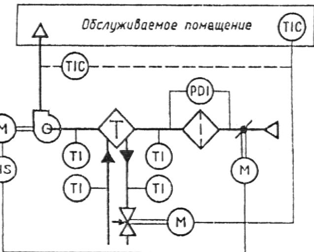
Примечание — Буквенные обозначения измеряемых величин и функциональных признаков приборов, указанные на схеме и в таблице, приняты по ГОСТ 21.404.
