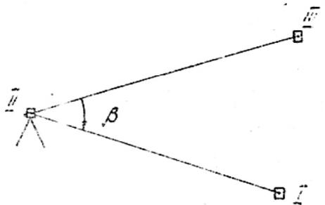
Рис. 2.3. Съемка измерения горизонтального угла
