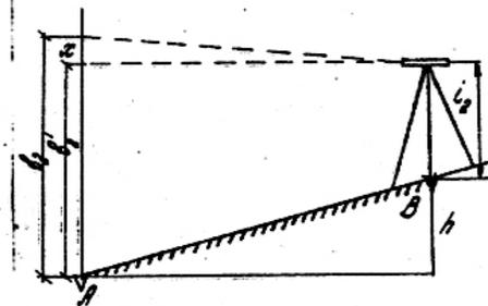
Рис. 1.3. Схема выполнения поверки главного условия
